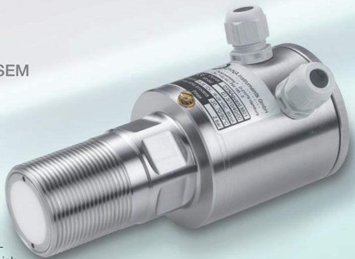
*Das Mikrowellen-Messprinzip beruht auf dem physikalischen Prinzip des Doppler-Effektes. Der Sensor sendet ein Mikrowellenfeld aus, was durch Feststoffe, die sich durch das Feld bewegen reflektiert wird. Der Sensor wertet die reflektierten Wellen aus und setzt sie in einen Schaltvorgang um. Ruhendes Material wird nicht erfasst.*
